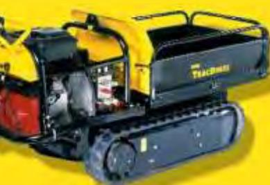
**Применение:** привод гидравлических инструментов; транспортировка инструментов, оборудования, мусора
