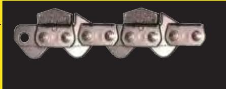
Алмазные цепи с SealPro™ работают при гораздо более низком давлении воды, чем алмазные цепи без уплотнения, что полностью устраняет необходимость использования насоса подкачки. Новые цепи можно использовать с водой из обычного садового шланга, и даже при давлении всего 20 фунтов на дюйм они прослужат удивительно долго. Отсутствие насоса подкачки означает дополнительную простоту установки, снижение временных затрат на выполнение работ и экономию воды.
