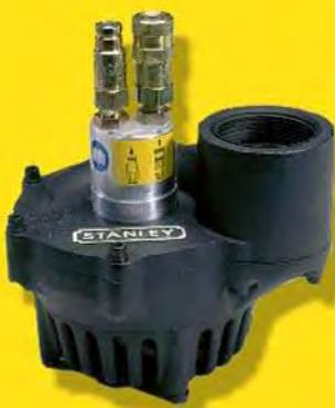
SM20 — один из самых легких и надежных насосов; полностью погружной, с мощностью 250 гал/мин (946 л/мин) при напоре 10 футов. Возможность перекачивания вод с содержанием твердых частиц размером до 5/16 дюйма делает этот насос идеально подходящим для осушения люков и подвалов. К преимуществам SM20 относятся входное отверстие из литого алюминия, рабочее колесо из уретана и двигатель Hugrev™. В стандартной комплектации поставляется с герметичными быстроразъемными соединителями.
